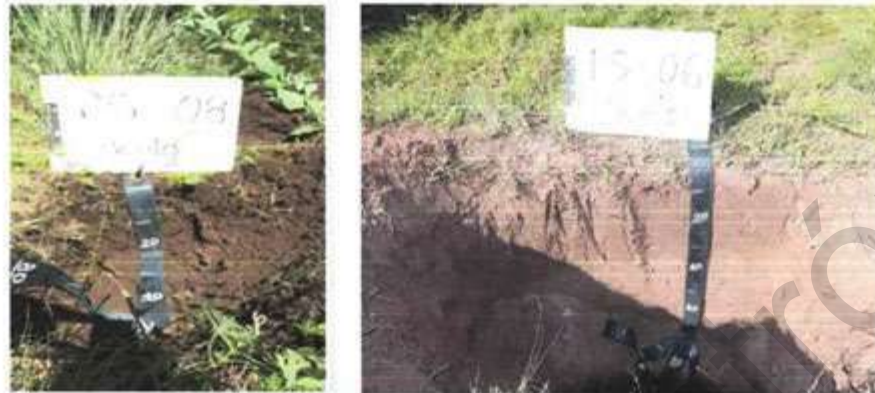
Figura 40. Tipo de suelo Luvisol en Presa Jaramillo (izquierda) y Vertisol en Santiago Tiapacoya (derecha).
